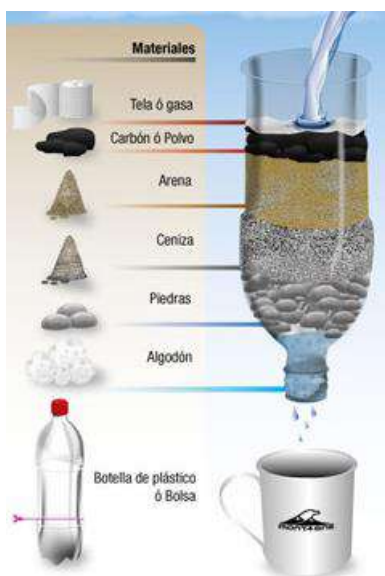
Figura 3. Filtro para la eliminación de contaminantes del agua (arsénico y flúor).
